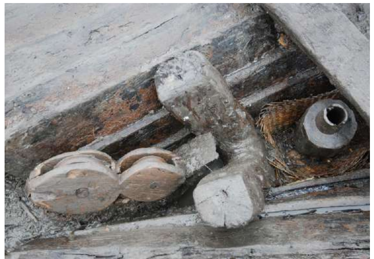
FIGUR 3.4.12 B I akterenden av Barcode 14 stod fremdeles både pumpehuset i en flettet kurv og en fiolinblokk.
