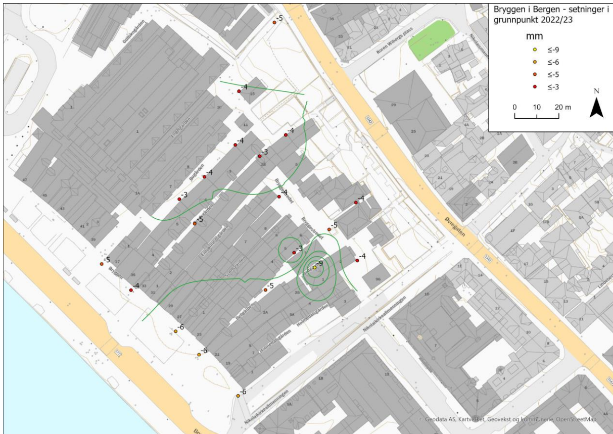
Figur 3-25. Setningsmålinger av punkter på grunnen fra 2022 til 2023. Prøvepunkt S6 er tatt ut.
