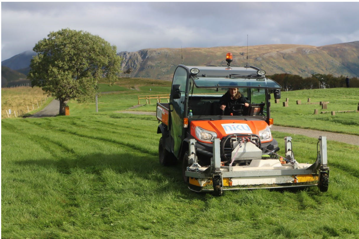
Figur 14: Georadarsystemet MALÅ MIRA under datainnsamling på Borg. Foto: JM/NIKU.
