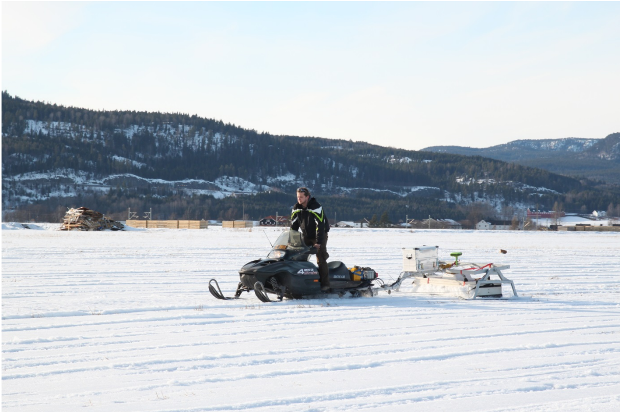
Figur 2: Motorisert georadarsystem ført med snøscooter. Fra undersøkelse ved Sande, Vestfold, vinteren 2013. Avbildet: Erich Nau, LBI/ZAMG. Foto: Lars Gustavsen, NIKU.
