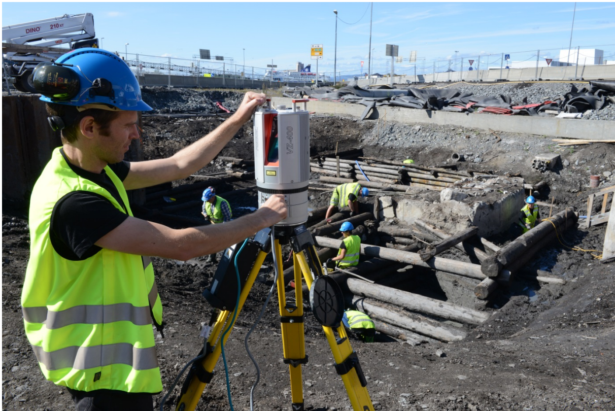
Figur 8: niku_ark_335027. Laserskanning av de fremgravde laftekassene. Foto mot sørvest.
