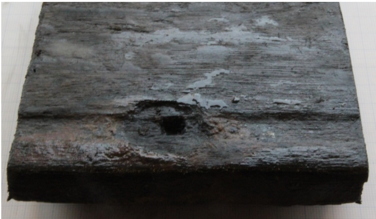
Figur 19: niku_ark_334936. Hudbord med profilstryk av typen «flat renne» i nedre kant på utsiden av bordet.
