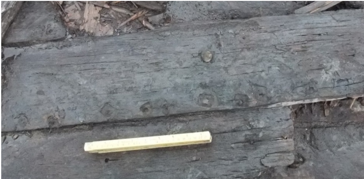
Figur 33: niku_ark_335408. Tettsittende søm i hudbord, forsterkning/reparasjon.
