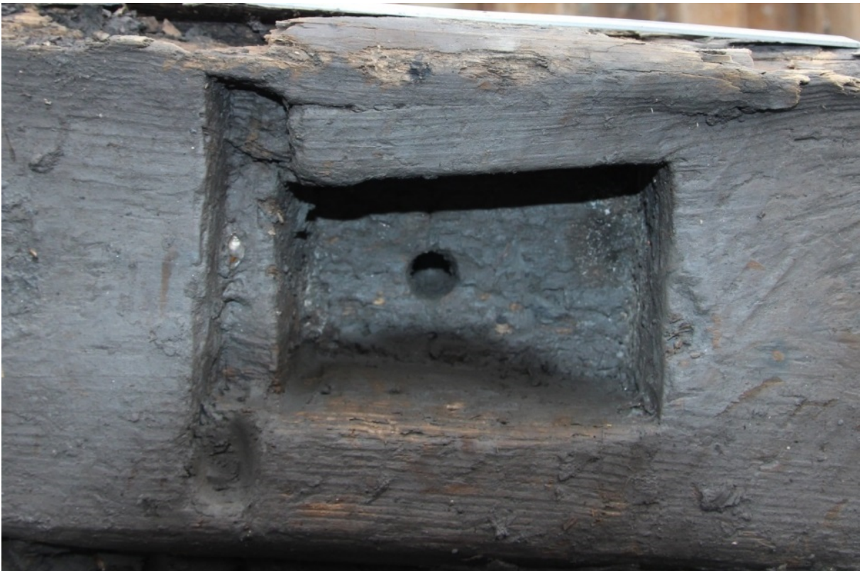
Figur 14: niku_ark_333965. Kjølsvin fra Nordenga, mastespor med dreneringshull, uthogg for vertikal planke/bjelke i framkant.
