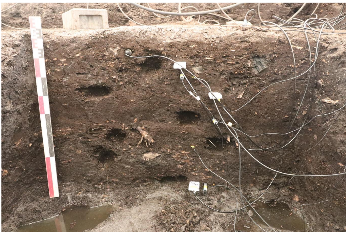
Figur 7: Målesensorer installert i miljøprofil 2 – C49576. Sett mot sør. Foto: Cf54086_NIKU_3453.
