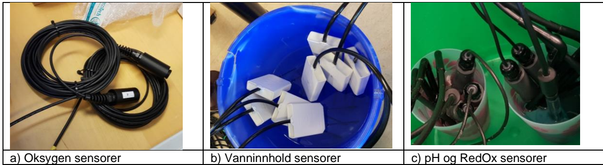
Figur 14: Illustrasjon av sensorer benyttet i profilene 1 og 2 i Middelalderparken Oslo. Foto: Cautus Geo AS.
