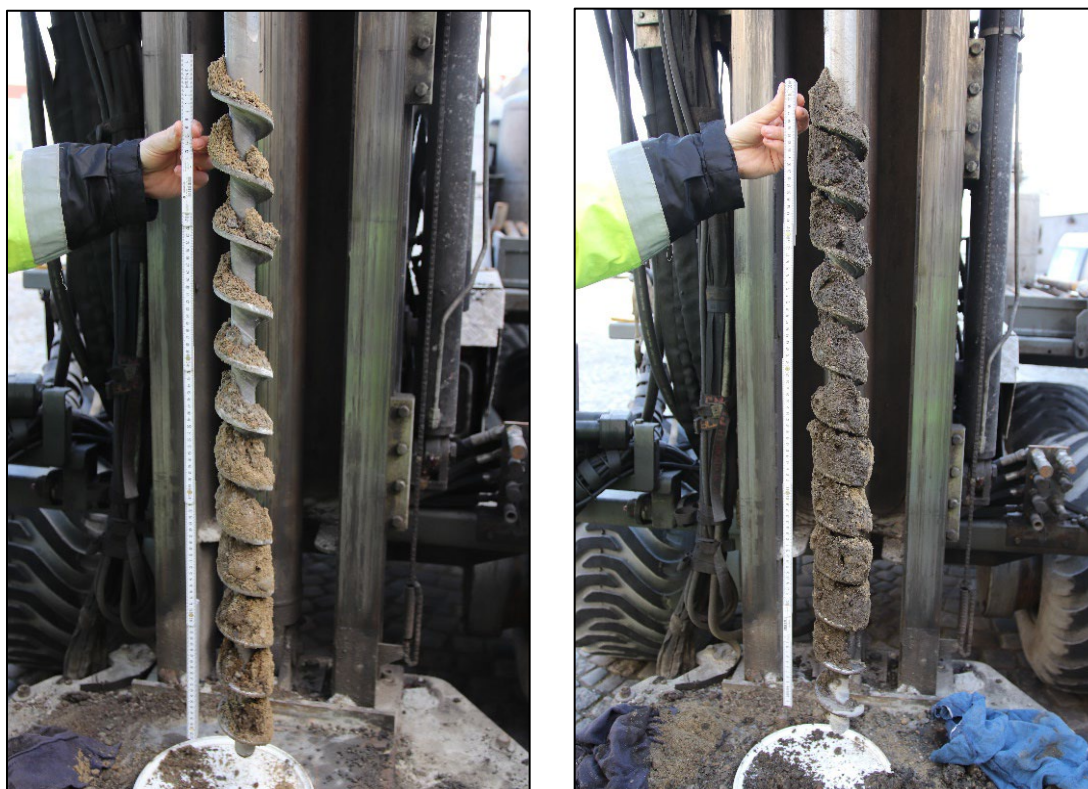
Figur 7. KS03, borelengdene 0–1 m dybde til venstre, 1–2 m dybde til høyre.
