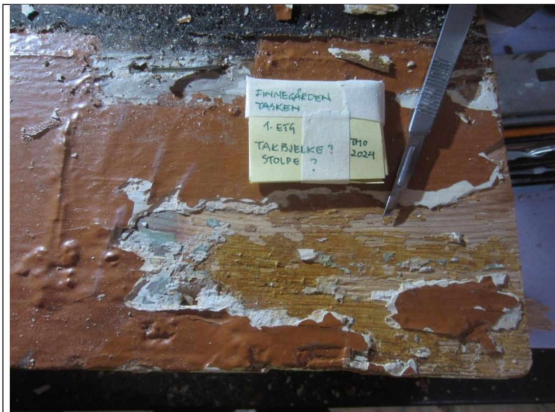
Plassering av uttaket av materialprøver fra side A er markert med kniven. Prøven delte seg ved uttak og ble støpt inn som to prøver; prøve 1 og prøve 2. Se tverrsnittene under.
