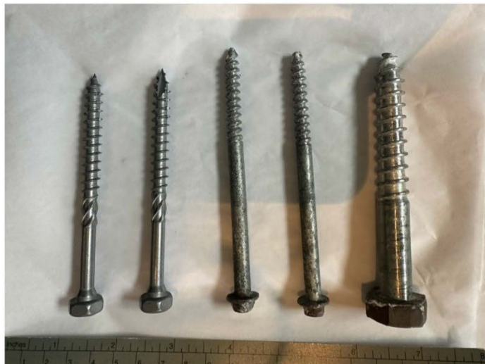
Fig. 5: Skruene til å feste krusifikset. To skruer (i midten) ble skiftet (skruene til venstre)
