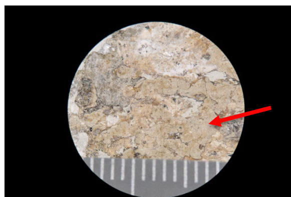
Figur 10 Avdekning på prøve fra horisontalt felt over konsollene på takgesimsen, fotografert gjennom mikroskopokular. Fasadens opprinnelige farge markert med rød pil. Foto: NIKU, 2024.
