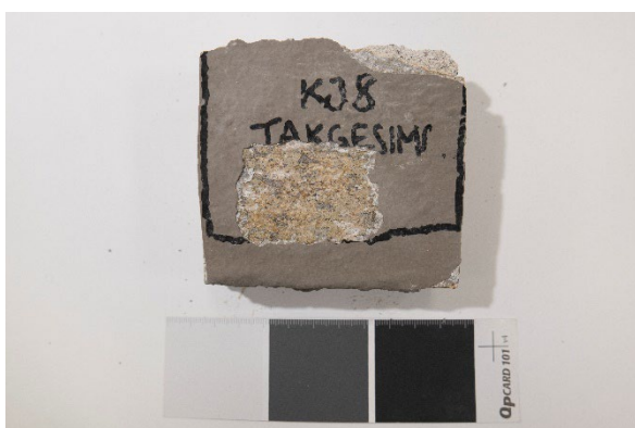
Figur 9 Avdekning på prøve fra horisontalt felt over konsollene på takgesimsen. Foto: NIKU, 2024.
