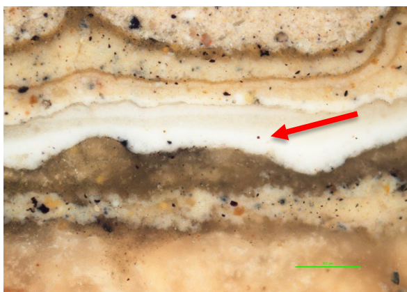
Figur 17 Tverrsnitt av de tidligste malingslagene på felt mellom konsollene på takgesimsen. Fotografert med pålys. 20x forstørrelse. Første, lyse malingslag er svakt pigmentert med sorte, gule og røde pigmenter, markert med rød pil. Foto: NIKU, 2024.
