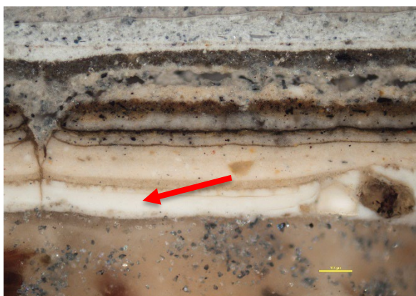
Figur 33 Tverrsnitt av de tidligste malingslagene på vindusomrammingen i 2. etasje. Fotografert med pålys. 10x forstørrelse. Første farge markert med rød pil. Under ligger et tynt, pigmentert grunningslag. Foto: NIKU, 2024.
