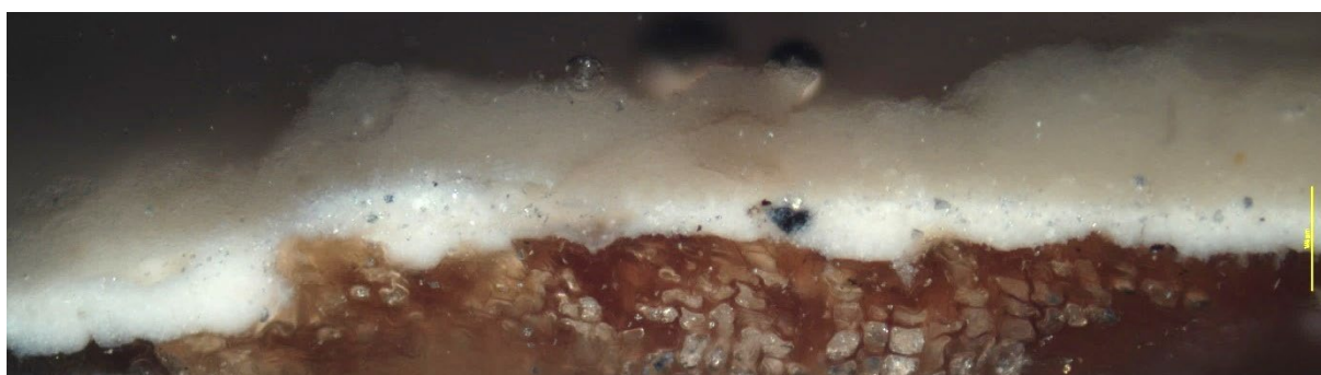
Figur 13 VB11 Ramme varevindu, materialprøve 6 (delt), 10x.
