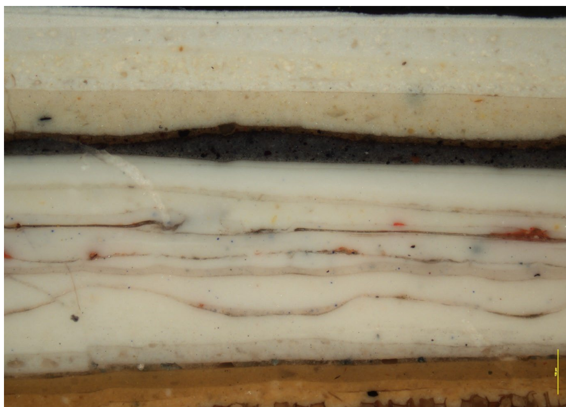
Figur 17 VB23 Gerikt, materialprøve 8, 10x. To oppmalinger med gulbrunt innerst.
