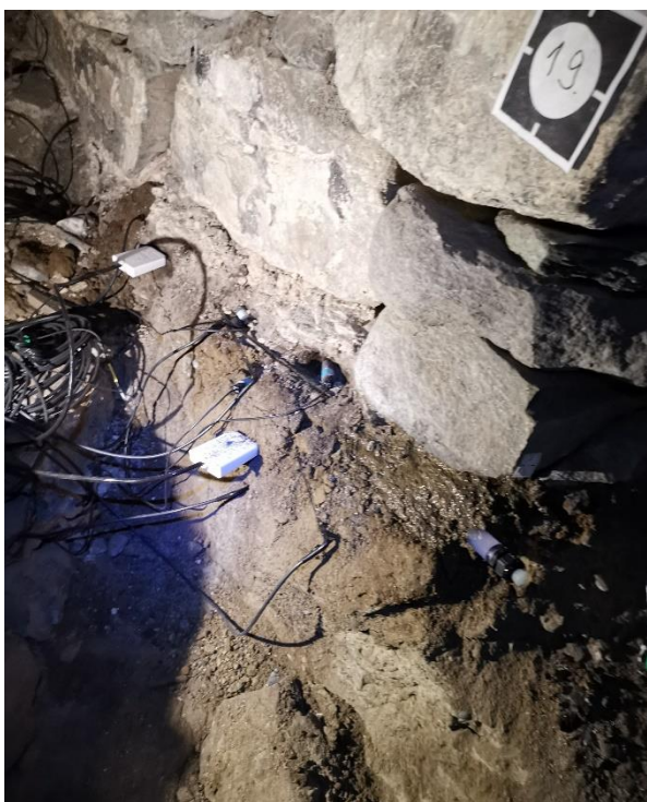
Figur 36: Sensorer installert i miljøprofil 1. Foto: Cautus Geo AS.
