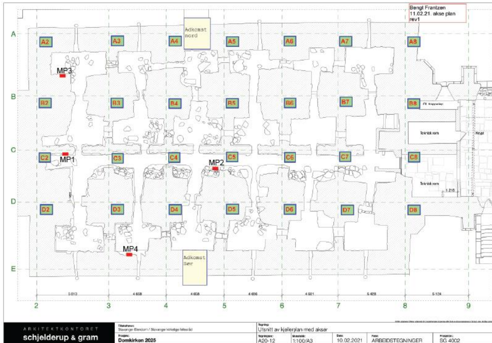
Figur 2: Akseplan over krypkjellerens kammerinndelinger, med miljøprofil (MP) markert i rød firkant. Kabler fra sensorer ble lagt i føringsrør i krypkjellerens midtgang frem til skap for datalogger plassert i «teknisk rom». Kamrenes benevnelse er merket øverst i venstre hjørne.
