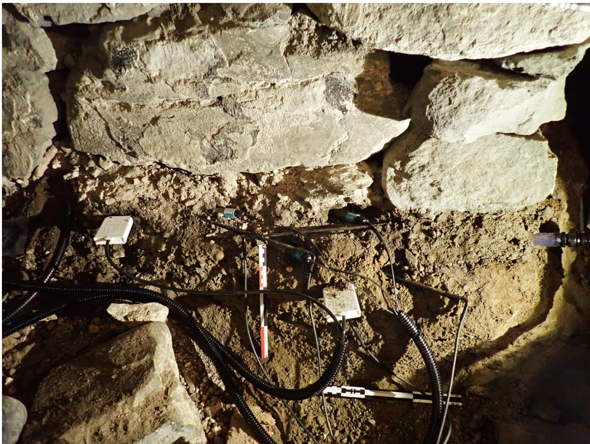
Figur 4: Målesensorer installert i miljøprofil 1. Sett mot nordvest. Foto: Sf223952.
