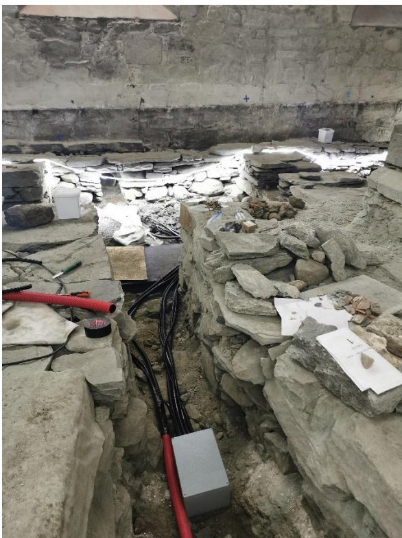
Figur 24: Tv.: Koblingsmodul for pH/redoks liggende nord for miljøprofil 4, ut mot krypkjellerens midtgang. Sett mot sør. Foto: NIKU. Th.: Skap for datalogger ved «teknisk rom» under koret i domkirka. Sett mot nordøst. Foto: Sf223957.
