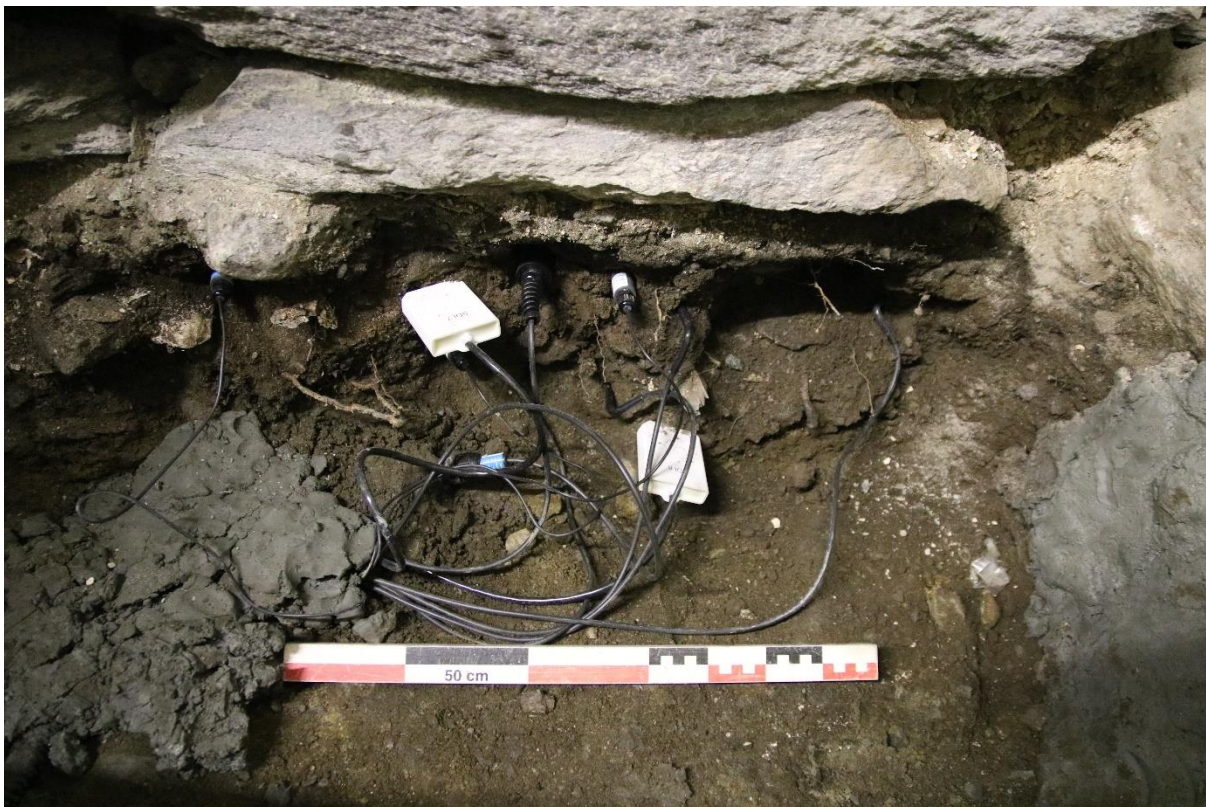
Figur 13: Målesensorer installert i miljøprofil 3. Sett mot sør. Foto: Sf223945.
