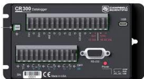
Figur 31: CR300 datalogger. Foto: Cautus Geo AS.
