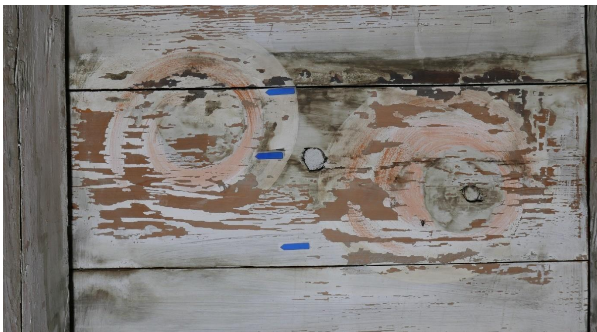
Figur 16 Detalj av dekor på himlingsbord. Områder med opprinnelig og sekundær rød farge. Pigmentene ble undersøkt med håndholdt XRF for grunnstoffanalyse. Den nederste pilen viser til et antatt hvitt område som skulle fungere som referanse av hvit bunnfarge ved analyse av figurfargene. Området viste seg, til vår overraskelse, å inneholde arsen. Området er ikke synlig gult. Kan det inneholde arsenikk, som er hvitt? Foto: Wedvik/NIKU 2022.
