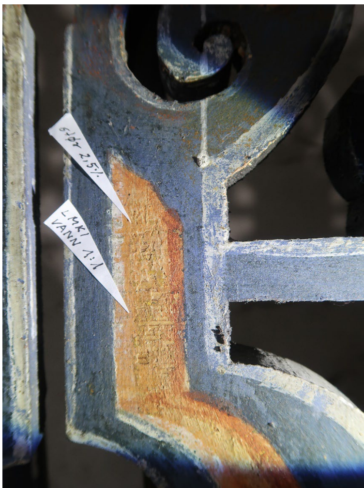
Figur 22 Oversikt over konsolideringstester på bekroningen. Beva 371 ble prøvd ut på et senere tidspunkt i et område litt nedenfor. NIKU CSp
