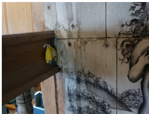
Fig. 66. Klimalogger B. 5.6.2023. Plassering på korskillet, nær nordveggen. Inneklima bør logges i minst 13 måneder.
