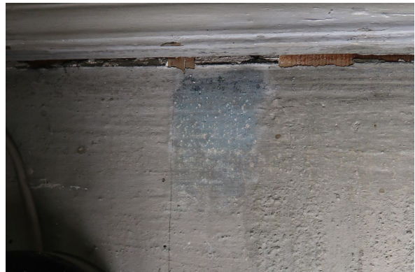
Fig. 20. Detalj av en rensetest med vann på den lys blågrå overmalingen øverst på veggmaleriet som viser at fargen opprinnelig var blåere. Nordvegg.
