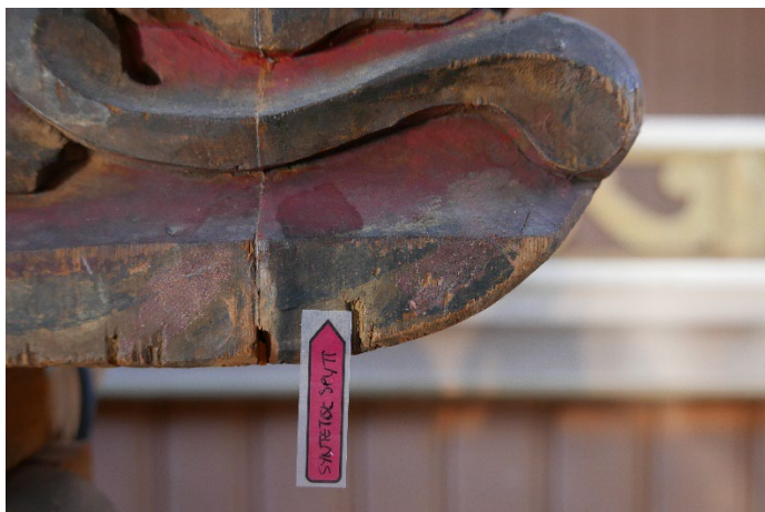
Fig. 14 Detalj rensetest. 2. etasje, høyre vange, syntetisk spytt påført gjennom kompress med japanpapir tok en del av smus-sen som ser ut å være inngrodd i den røde malingen.
