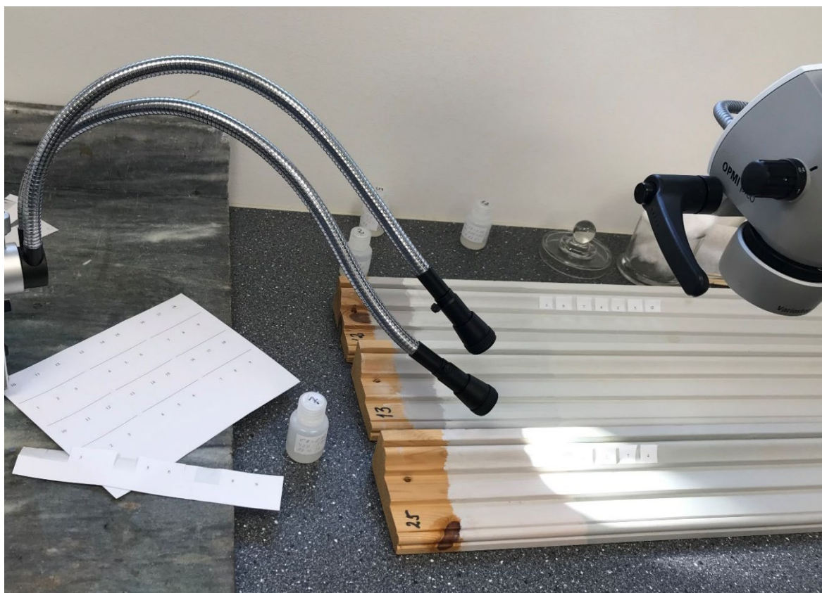
Figur 1 Foto av testflater A-C, oppstrøksprøver i linoljemaling fra 2011. Overflaten ble under testing observert gjennom stereomikroskop.
