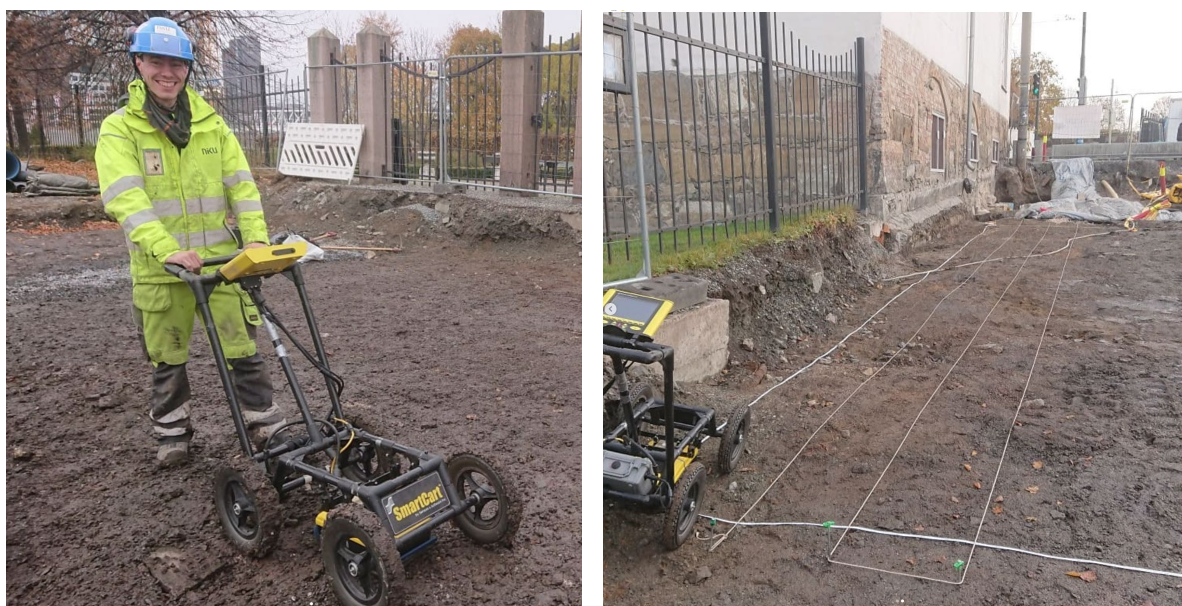
Figur 111: Jani Causevic med 1-kanals georadar (venstre) og rutenettet for georadaren (høyre), som gikk rett sør for Ladegårdshagen og Ladegårdens sørvegg. Bilder tatt henholdsvis mot nordvest og øst av Stefan Bakke.
