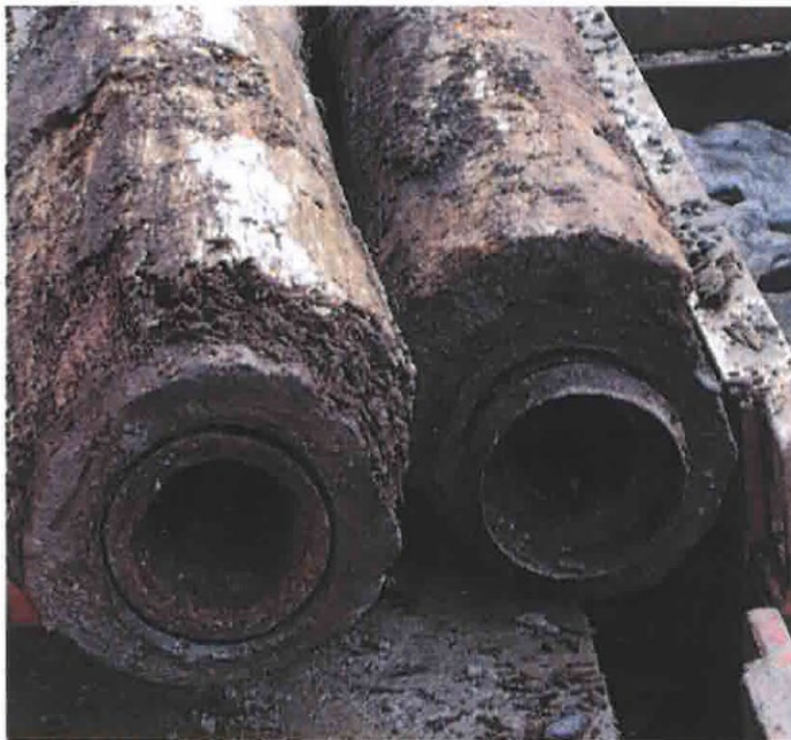
Figur 121: Rør fra byens siste trerørsledning gravd opp i Maridalsveien i 2000. Bilde: Oslo kommune vann og avløpsetaten (Johansen, 2001).
