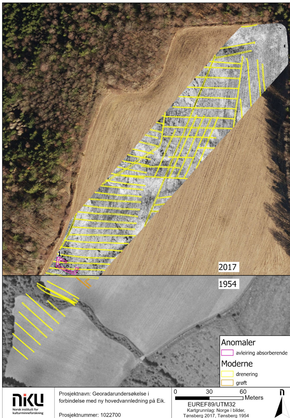
Figur 7: Området B måler 1,8 hektar og er dekket av anomalier som er tolket som moderne drenering. Disse ligger stort sett tydelig strukturert, med unntak av en liten gruppe i sør som sammenfaller godt med en vegetasjonsstripe, sannsynligvis en bekk, synlig i flyfoto fra 1954. I de geofysiske dataene er det også identifisert en trapesformet absorberende struktur (1) av ukjent funksjon og opphav.
