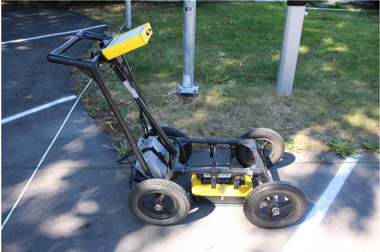
Figur 3. Enkeltkanals georadar av typen Sensors & Software ved Oslo hospital. Foto: Liv Avset/NIKU.
