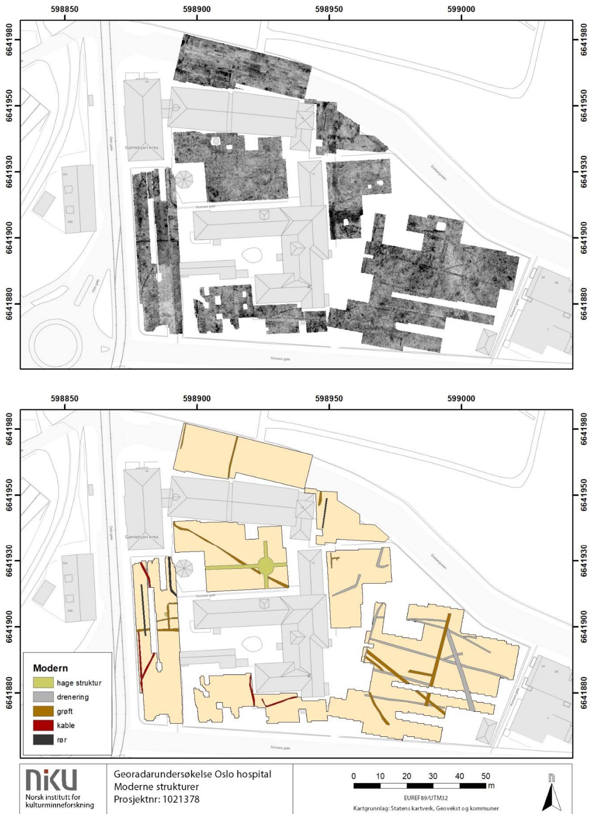
Figur 6. Tolkning av moderne strukturer i georadardataene.
