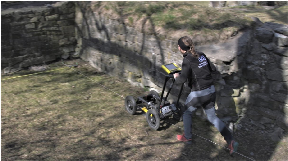
Figur 5: Kjøring av enkanals georadar på klosterområdet, der posisjonering skjer i henhold til lokalt rutenett med kjørelinjer. Bildet er tatt i delområde CD, sett mot NV. Foto: TW/NIKU.
