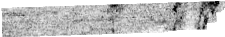
Figur 5: Dybdeskive fra del 4, relativ dybde 20-30 cm. De kraftige anomaliene tolkes som geologi, trolig berg nær overflaten.
