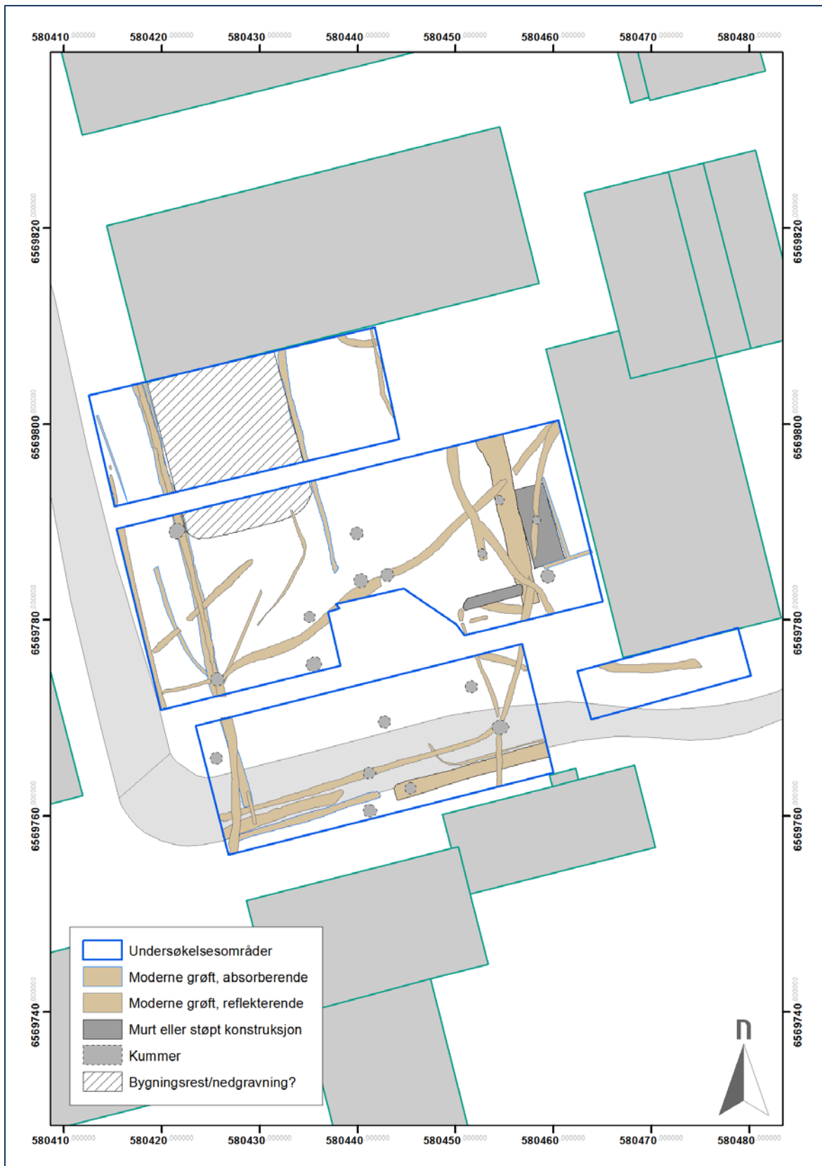
Figur 6: Oversikt over påviste strukturer i nivået 50-90 cm dybde under overflaten. Kart med strukturnummer finnes i kapittel 7. Kartgrunnlag: Statens kartverk, Geovekst og kommuner.
