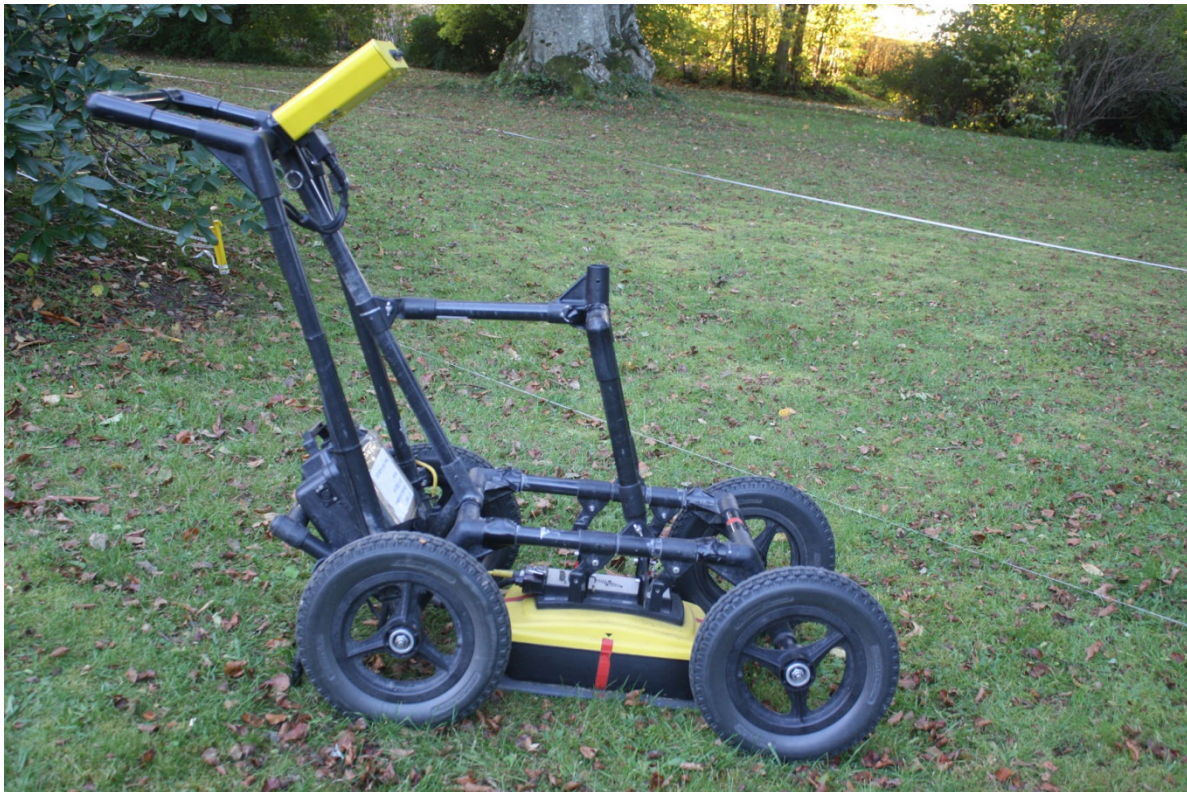
Figur 20: Georadarsystemet har en viss likhet med en barnevogn. Radarantennen er montert rett ovenfor bakken på en glideplate. På kontroll- og dataopptegnings-enheten får operatøren fram vertikale radarprofildata og viktige måleparametre. For posisjonering av måledata langs profillinjen finns et distansehjul montert på en av vognens hjul. Systemet kjøres langs med opp till 100 m lange parallelle linjer over undersøkelsesområdet.
