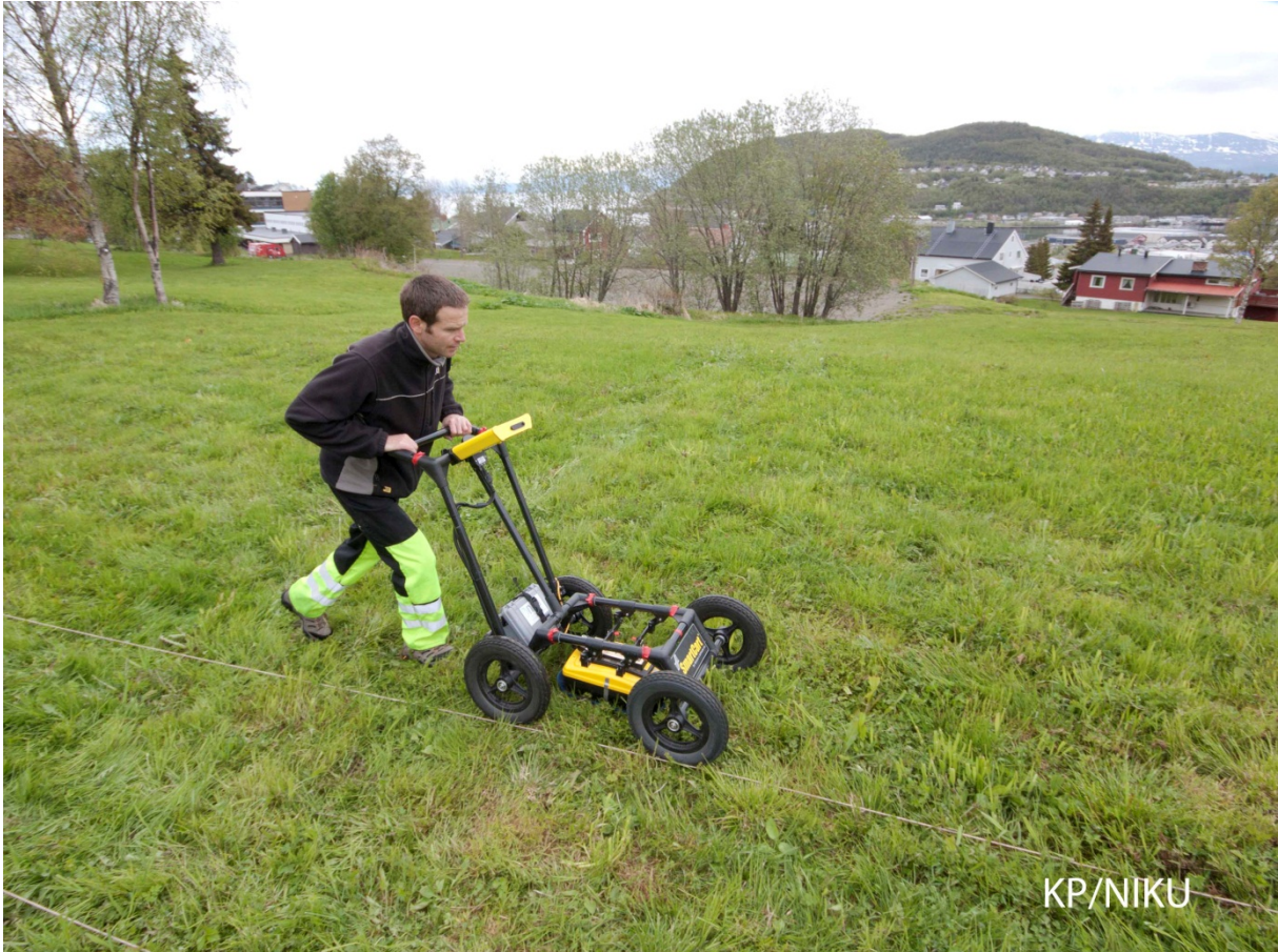
Figur 2 - Georadarundersøkelse ved Saurbekken. Utstyret som er brukt er et Sensors and Software Noggin 500 enkeltkanalssystem. Foto: KP/NIKU
