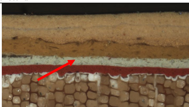
Figur 24 Tverrsnitt av alle malingslagene på karmen. Det grønne laget (rød pil) kan være laget fra 1980-tallet, se tabell fra 2020 nedenfor.
