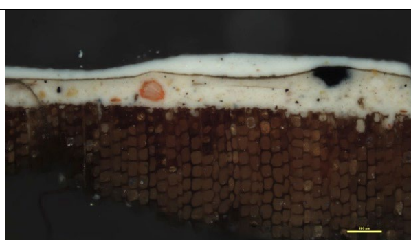
Figur 55 Tverrsnitt av fargelag på vindusrammen mot rom 202-203. Nedre-høyre-oppe. Fotografert med pålys. Prøven er fremstilt i 2023.
