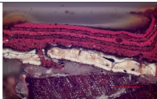
Figur 66 Tverrsnitt av malingslagene på ytre vindusrammen. Fotografert med pålys.
