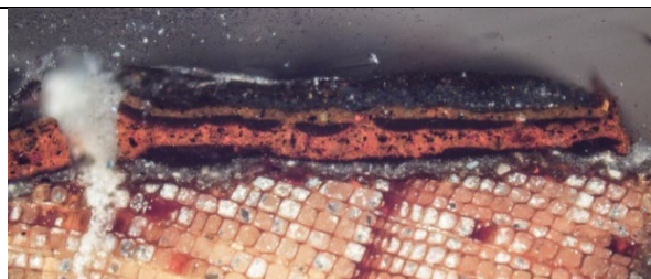
Figur 3 Tverrsnitt av prøve 3. 10 x forstørrelse. Fotografert med pålys.
