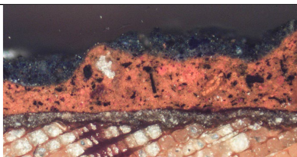
Tverrsnitt av malingslagene på balusteren i 3. etasje. 10x forstørrelse. Fotografert med pålys og UV-lys.
