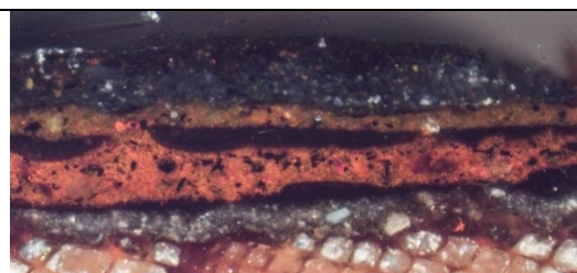
Tverrsnitt av malingslagene på balustren. 10x forstørrelse. Fotografert med pålys og UV-lys.
