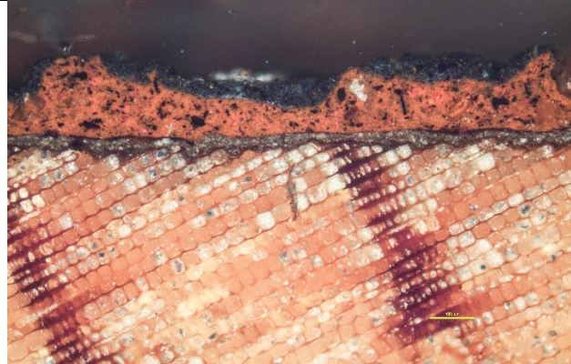
Figur 1 Tverrsnitt av prøve 1. 10x forstørrelse. Fotografert med pålys.
