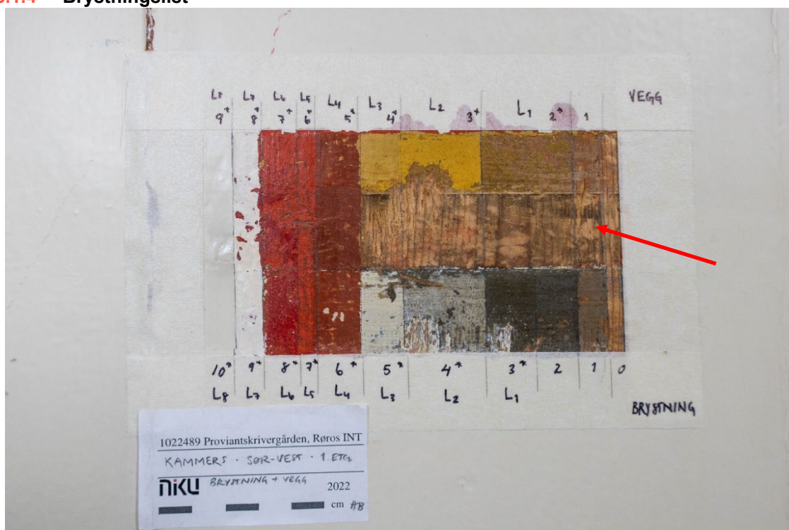
Figur 21 Lagvis avdekking på veggpanel mot sør. Avdekkingen er gjort i overgangen mellom vegg og malt brystning. Det umalte feltet er negativ fargespor etter brystningslist (markert med rød pil). Det negative fargesporet er ca. 2,3 cm bredt og ca. 80 cm fra nåværende gulv. Sporet går tilnærmet i flukt med bunnen av karmen til vinduet på sørveggen. Lista ble fjernet da veggen ble malt rød helt ned til tidligere, høy fotlist. Foto: NIKU, 2022.
