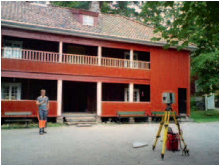
Oppmåling av Kartesrudbygningen, Norsk Folkemuseum, med terrestrisk laserskanner. Alle fotografiene i artikkelen er tatt av NIKU i 2010.
