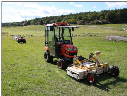
Figur 7. Bruk av motorisert geofysikk i Vestfold i 2010. Systemet i forkant av bildet består av en flerkanals georadarskinne som dyttes av en minitraktor, mens det bakerste systemet består av flere magnetometre som trekkes av en ATV. Foto: Lars Gustavsen, NIKU.
