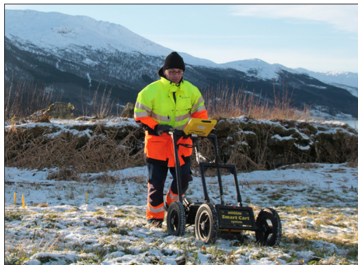
Figur 4. Bruk av georadar ved Auduns borg i Jølster kommune, Sogn og Fjordane. Foto: Lars Gustavsen, NIKU.
