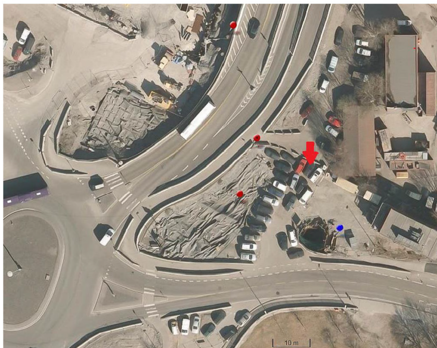
Figur 1 Oversikt over miljøbrønner ved Bispegaten, Bjørvika, Oslo. Røde markeringer er eldre miljøbrønner DEG 4, 5 og 7. Den nye DEG8 er markert med rød pil. Blå markering er avsluttet miljøbrønn S7 som ble slått i stykker ved anleggsarbeidet juni 2013.
