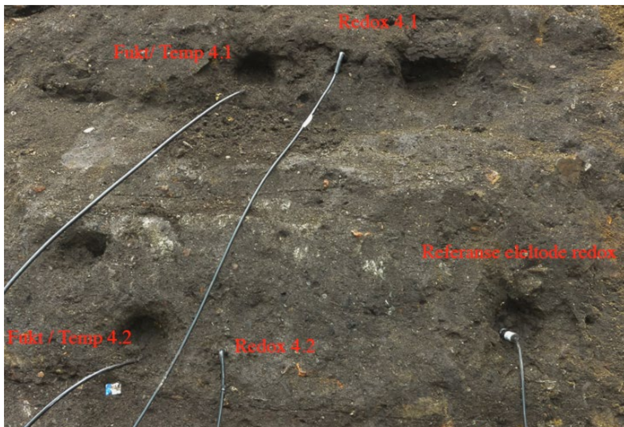
Figur 11 a og b. a) Hull 4 profil 1 med sensorer (over) og plassering ref. elektrode (under). b) Plassering ref. elektrode for redoks målinger ble valgt i representativt lag 4.2. Foto: NIBIO.
