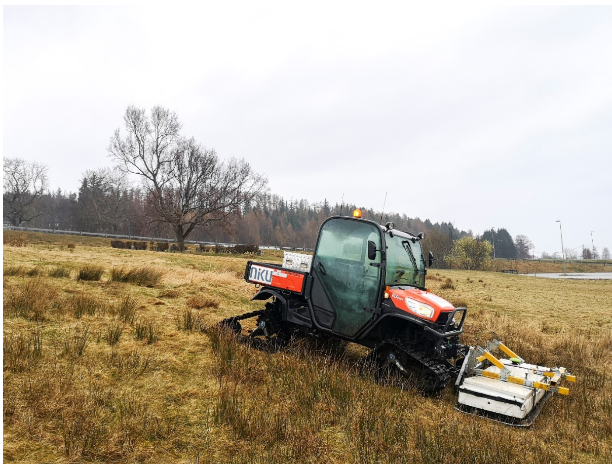
Figur 7. Georadar MIRA3 ved Bremsnes tingsted våren 2022. Bild: Manuel Gabler, NIKU
