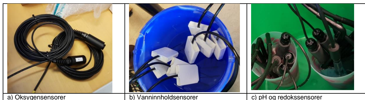
Figur 2. Sensorene brukt i miljøprofilene i Erling Skakkes gate.
