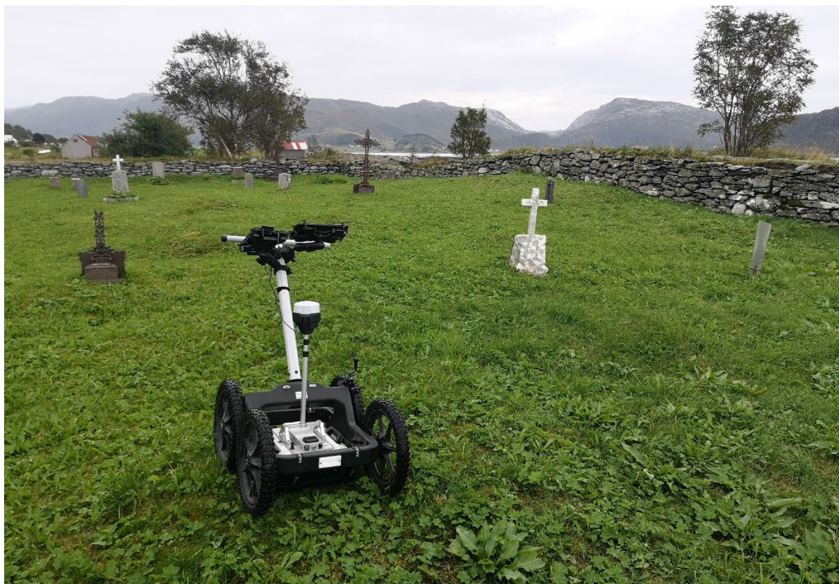
Figur 4: Enkeltkanals georadar, Malå GX 450 med RTK GPS Emlid RS2 i aksjon på Grotle gamle kyrkjegard. Foto: MG/NIKU.
