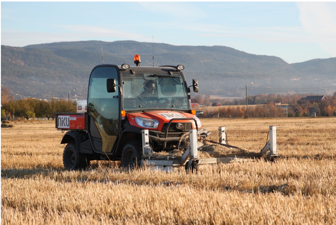
Figur 6: Georadarsystemet Malå MIRA. Foto: NIKU
