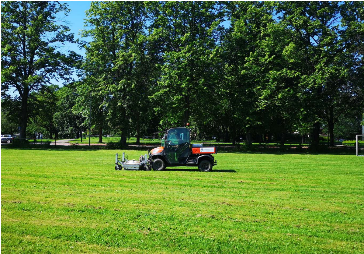
Figur 5: Georadarsystemet Malå MIRA, her under kjøring på fotballøkken (delområde A). Foto: MK/NIKU.
