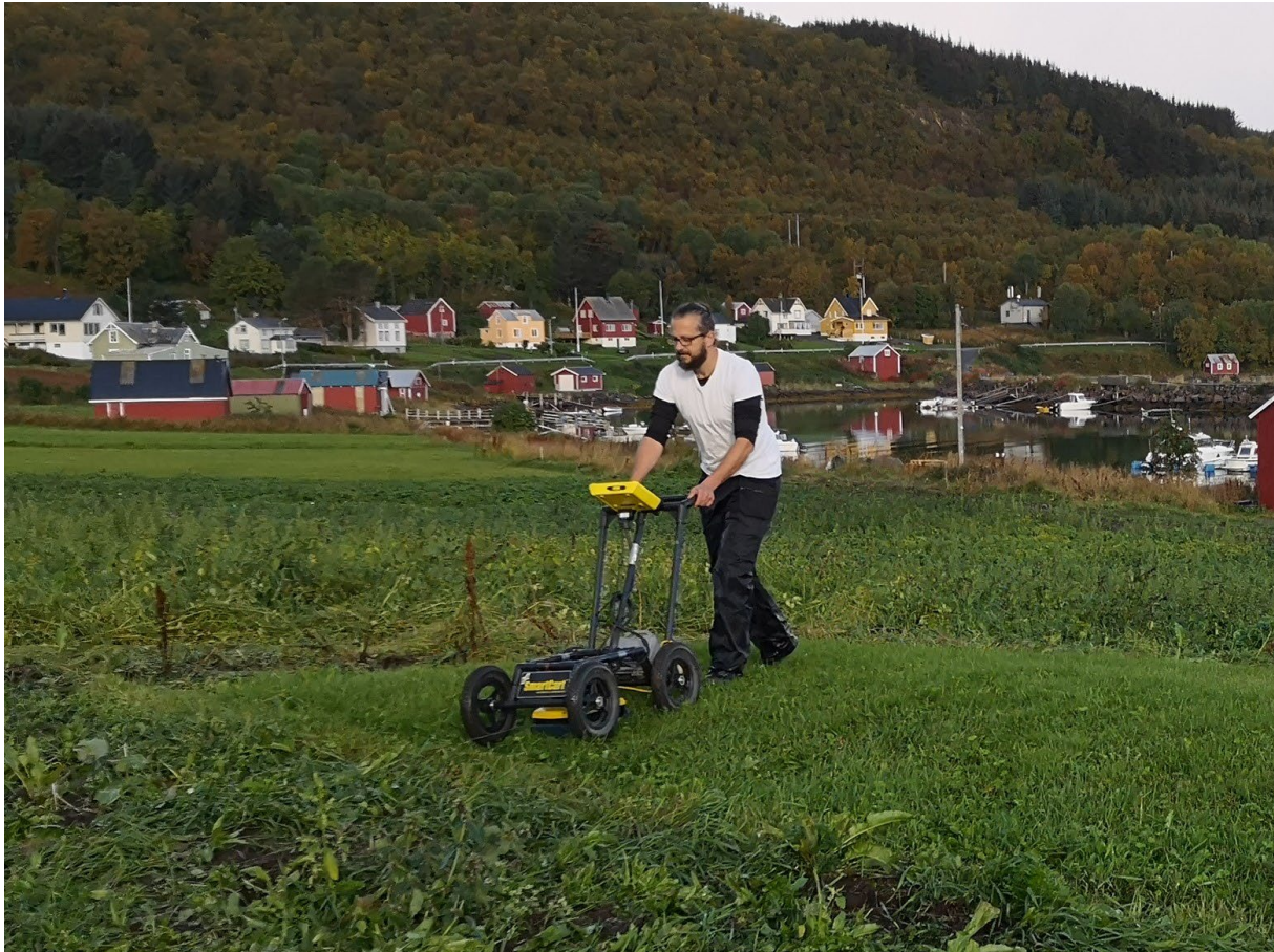
Figur 4: Erich Nau med georadarsystemet Sensors&Software Noggin 500 på Nergård. Foto: MK/NIKU.
