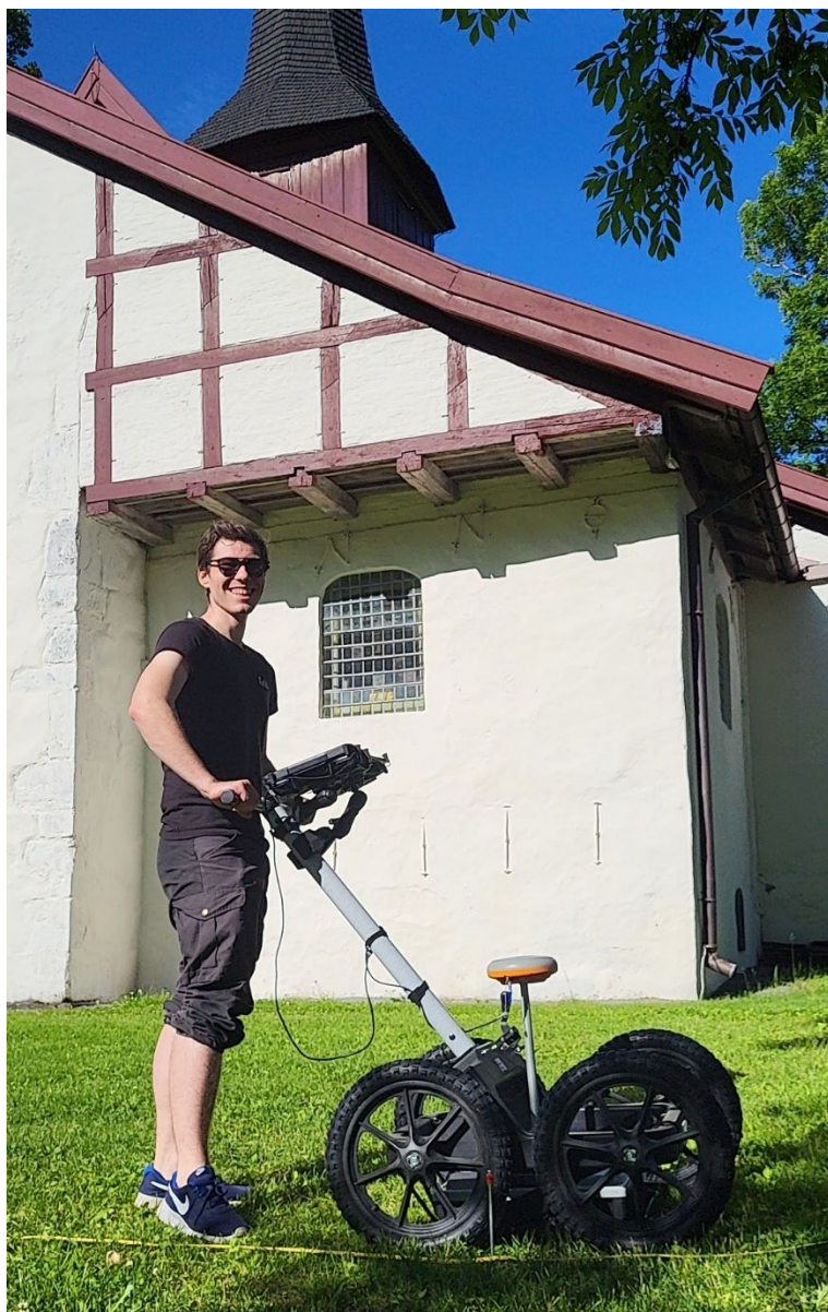
Figur 6: Jani Causevic med enkeltkanals georadar MIRA GX450 ved Tanum kirke. Foto: MK/NIKU.
