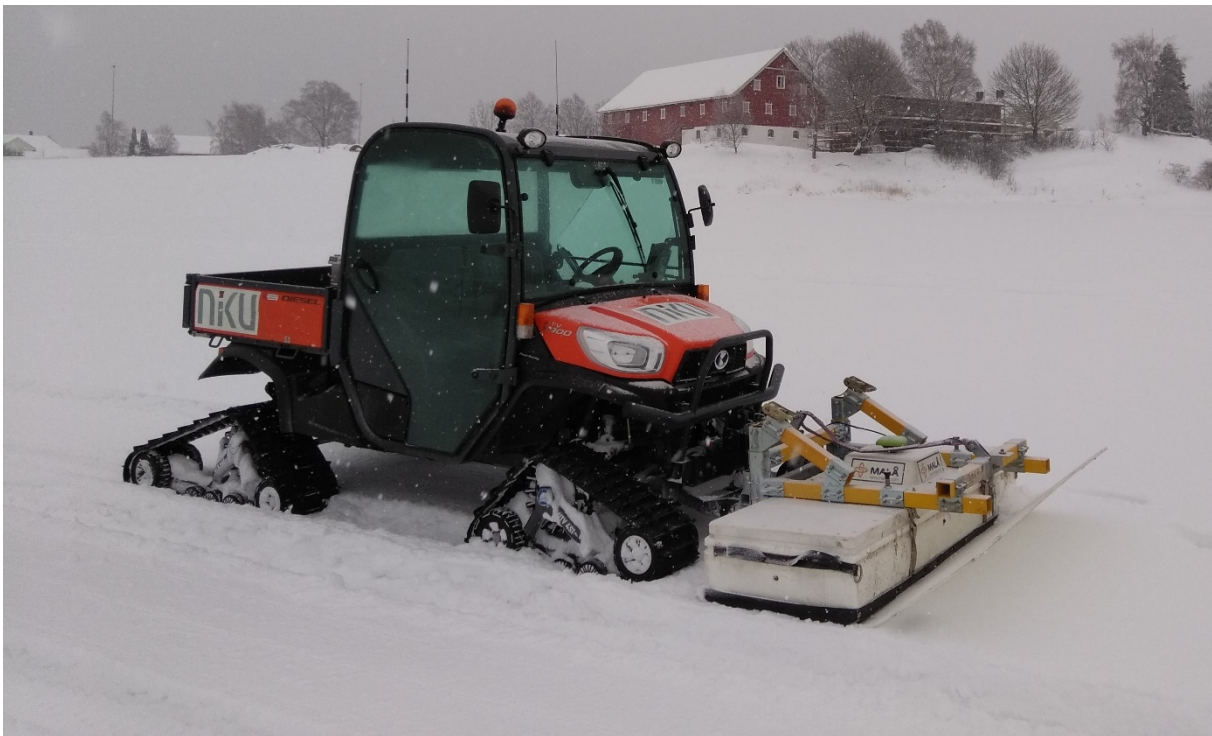
Figur 3: Det motoriserte georadarsystemet MALÅ MIRA med påmonterte snøbelter. Ekenes vest i bakgrunnen. Foto: MG/NIKU.
