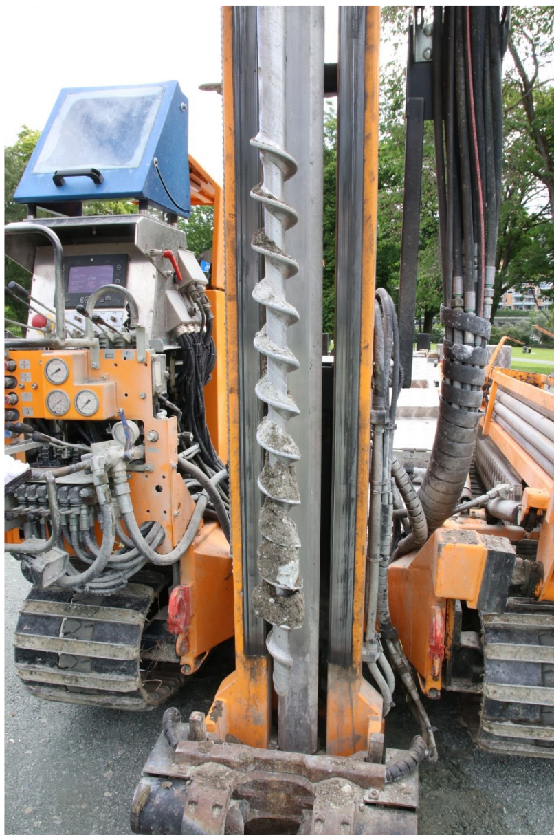
Figur 7. Boreprøve 4. Svært løse, moderne fyllmasser. Foto: NIKU.
