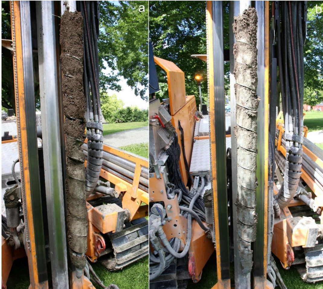
Figur 12. Boreprøve 20. a: 1-2 meter ned. b: 2-3 m ned. Foto: NIKU.
