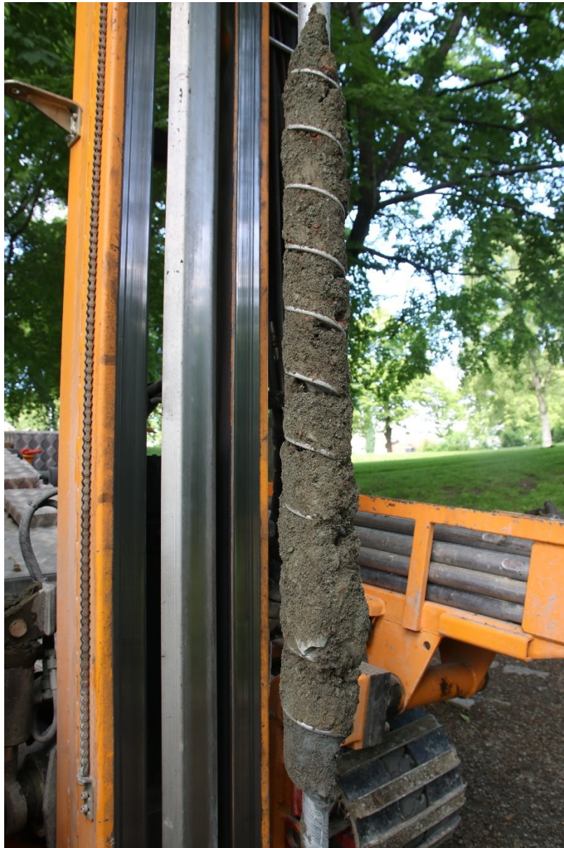
Figur 10. Boreprøve 18, 2-3 meter ned. Siltig, løs sand med tegl og stein over leire. Foto: NIKU.
