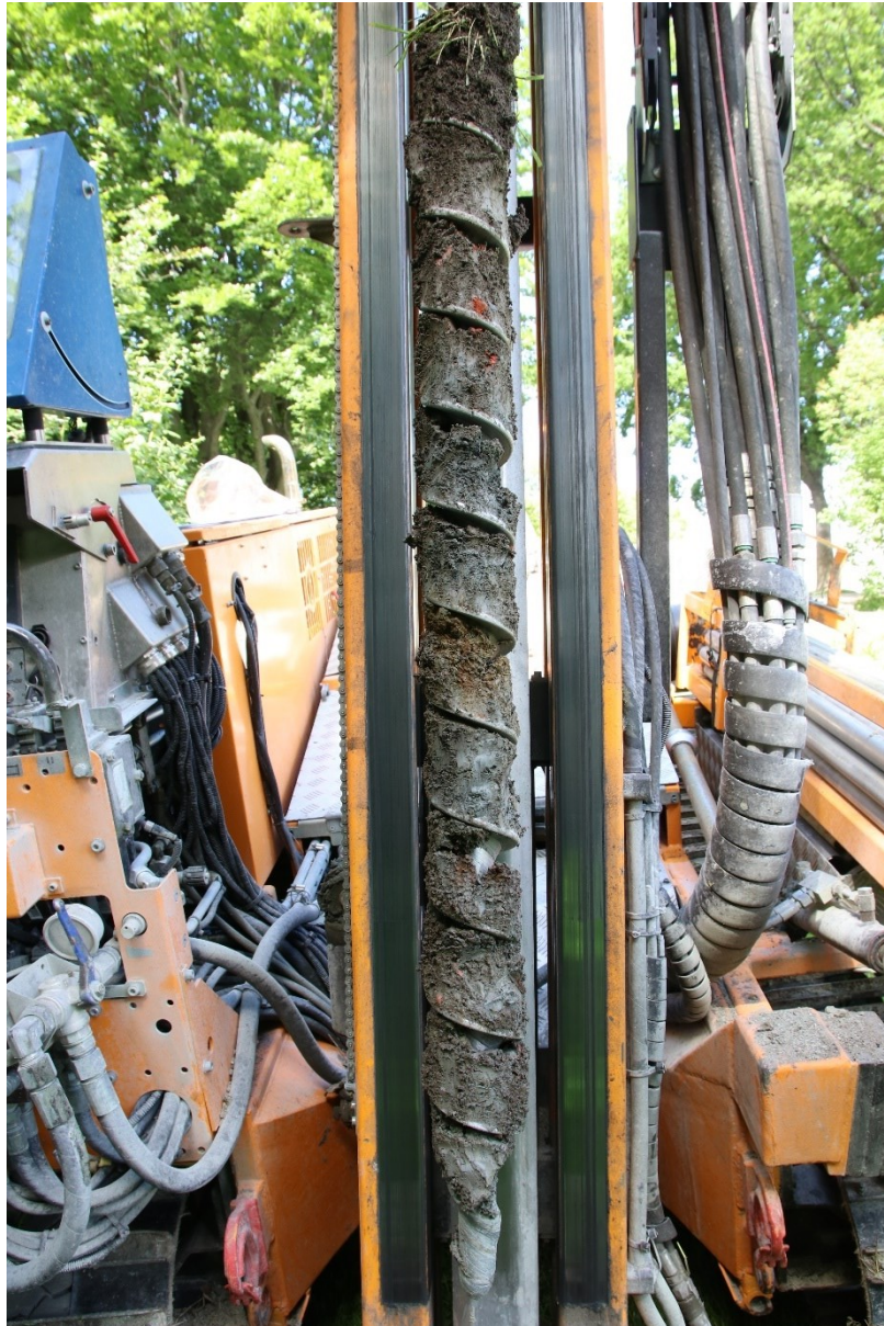
Figur 11. Boreprøve 19, 2-3 meter ned. Omrotet rasleire. Foto: NIKU.
