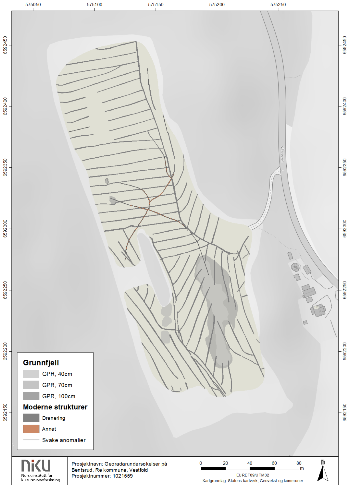
Figur 6: Anomalier som representerer moderne anlegg i bakken, samt grunnfjell som ligger nær dagen.
