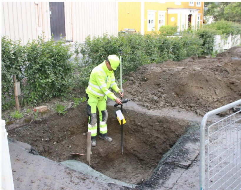
Figur 57: En stang med prisme på toppen sender signaler til en totalstasjon. På denne måten kan en kartfeste de ulike lagene med opptil centimeterspresisjon. Foto: Chris McLees, privat.
