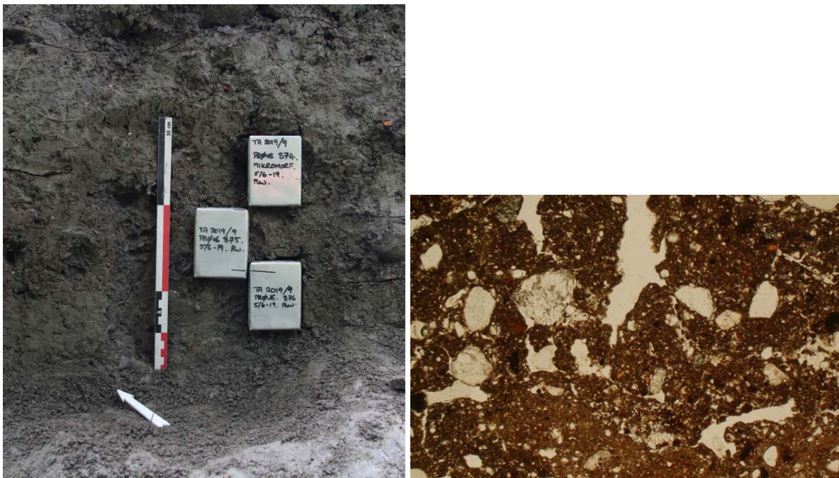
Figur 66: Ved mikromorfologisk analyse blir små bokser presset inn med overlapp inn i en profil (venstre). Disse blir så analysert i et mikroskop for å se hvordan lagene er bygd opp (høyre). Da62836_068 og Macphail 2020: 45.
