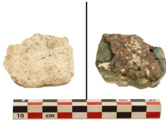
Figur 230: En bit mørtel med en side som er dekket i et glasslignende materiale, N207351:79. Slikt oppstår i forbindelse med sterk varme, enten brann eller i en ovn.
