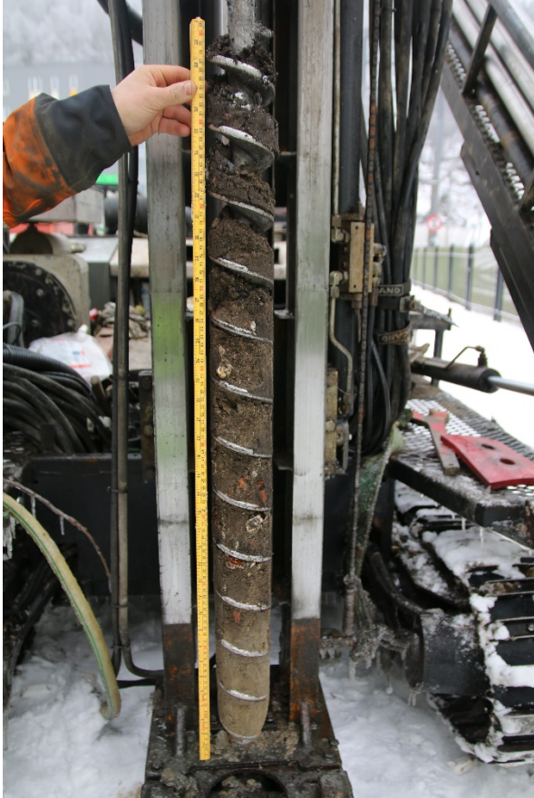
Figur 4: Borepunkt 303. 0-1 meter bestående av vekstjord med tegl og mørtel. Foto-nr: Cf53279_NIKU_0012
