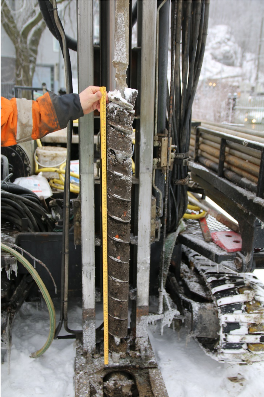
Figur 2: Borepunkt 304. Den øverste meteren med vekstjord og teglbiter. Foto-nr: Cf53279_NIKU_0005
