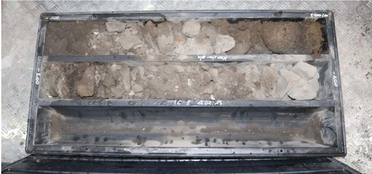
Figur 2: Jordsøyler fra IC1, tatt opp uten arkeologisk overvåkning 17.2.2017. Massene er svært løse, og søylen er derfor lenger enn den reelle bakkedybden. 0 m sees øverst til høyre, og -1 m nederst til venstre.
