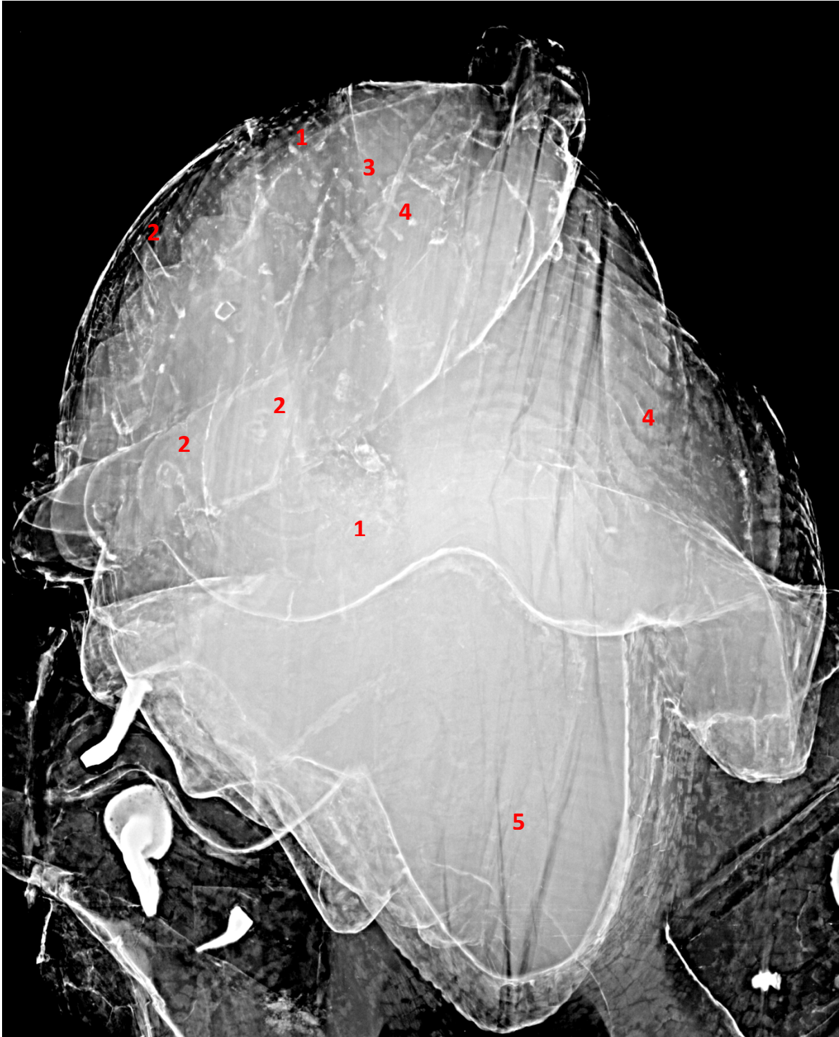
Figur 6. Røntgenbilde 2, skulpturens hode. Et stort og dypt hull i skulpturens hode vises som et mørkere område (1). Mindre firkantede former viser trolig huller der det har stått «torner», mindre treplugger, med avsetning av maling i overgangen mellom torn og krans (2). Kransens tvinning ses som lysere skrå linjer (3). Utskjæringene av hår og skjegg viser seg som lysere og mørkere bølger og linjer (4). Gjennomgående sprekker i treverket ses som mørkere vertikale striper (5). Foto: NIKU 2015.
