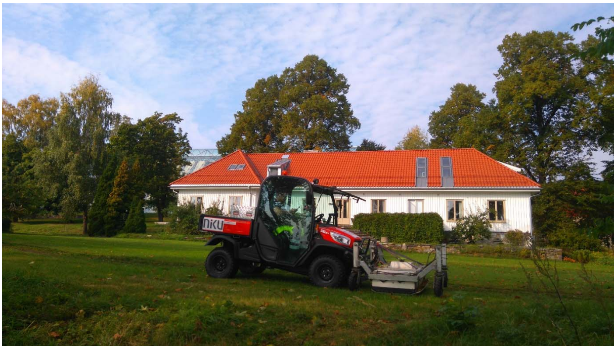
Figur 3: MIRA 3 på Bispegata. Foto viser MIRA box innfør Kubota RTV. JAVAD RTK GPS er montert på toppen av MIRA box. Foto: MG/NIKU
