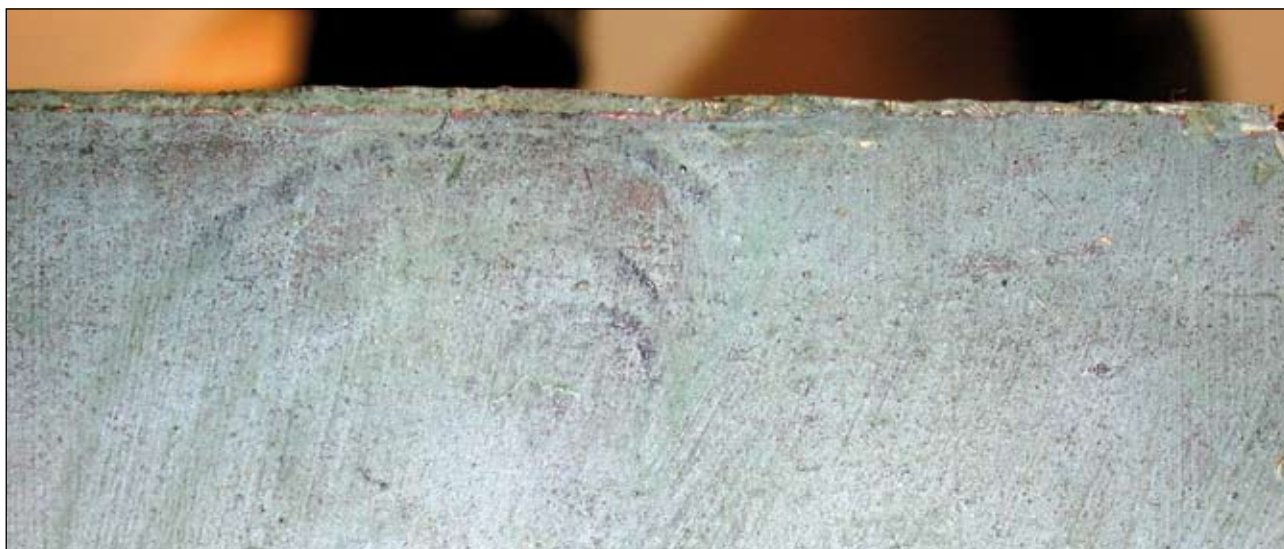
Figur 10. Øverst på bakveggen avsluttes den originale malingen litt innenfor kanten og i et litt tykkere lag enn nedenfor. Penselen har støttet mot en kant e.l. da bakveggen ble grundert og malt. Under den blå overmalingen – som fortsetter ut over øvre kant – skimtes et rødt malinglag. Foto: Mille Stein, NIKU, 2007.
