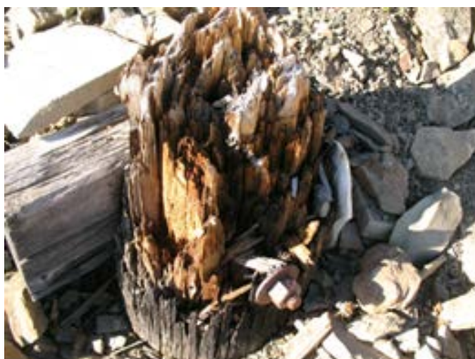
Foto 30. Hele indre del av den knekte stokken er kraftig svekket av råtesopp. Foto: J. Mattsson, Mycoteam
