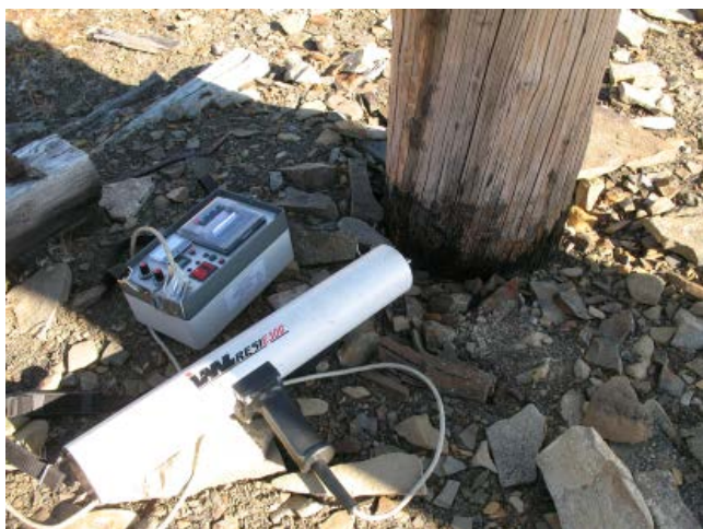
Foto 3 Bruk av råtedrill gir et nøyaktig resultat av holdfastheten i treverket gjennom hele stokken, til tross for at det kun blir et hull på ca. 2 mm i diameter i treoverflaten. Foto: AC Flyen, NIKU
