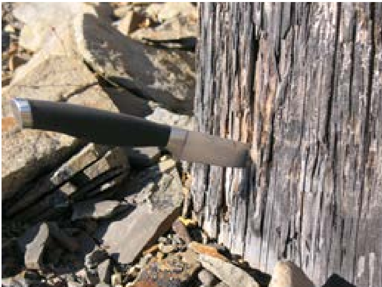
Foto 28 Resultatene ved bruk av kniv kan være vanskelig å tolke på Svalbard. Dette skyldes blant annet at det indre av stokken kan være frosset ettersom permafrosten gjør at bakken fryser nedenfra. Foto: AC Flyen, NIKU
